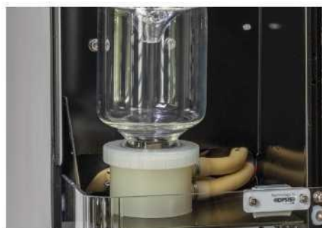
OCHRONA BlackLINE ORAZ POWLECZENIE NAJBARDZIEJ WRAŻLIWYCH CZĘŚCI PTFE. OPCJONALNIE POLIPROPYLENOWA GŁOWICA SPLASHHEAD.
